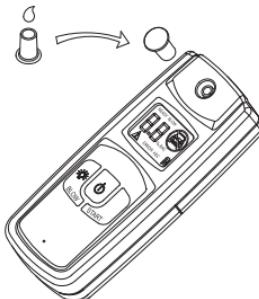
2. Jedním stiskem tlačítka "ON/OFF" alkohol tester zapněte. Proběhne automatický test, který potrvá 12 až 18 sekund, přičemž na displeji bud probíhat odpočítávání od 12 / 18 do 0 a na jeho závěr se rozblíká nápis "READY".
