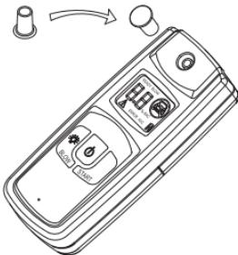
2. Jednym naciśnięciem klawisza "ON/OFF" tester alkoholu się załączy. Przeprowadza się test automatyczny, który trwa 12 aż 18 sekund, przy czym na ekranie przebiegnie odliczanie od 12 / 18 do 0 i pod koniec zacznie migotać napis "READY".
