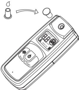
2. Включите устройство нажатием кнопки «ВКЛ./ВЫКЛ.» один раз, после чего активируется функция ASC; в среднем данная процедура занимает около 12 – 18 секунд, при этом на экране Вы увидите обратный отсчет с 12/18 до 0, затем появится надпись «READY» (ГОТОВ).
