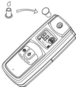
2. Jedným stlačením tlačidla "ON/OFF" alkohol tester zapnete. Prebehne automatický test, ktorý potrvá 12 až 18 sekúnd, pričom na displeji bude prebiehať odpočítavanie od 12 / 18 do 0 a na jeho záver sa rozblíká nápis "READY".
