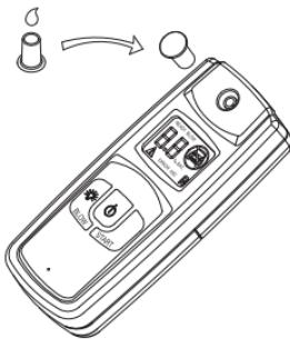
2. Увімкніть пристрій натисканням кнопки «ВКЛ/ВИКЛ» один раз, після чого буде активована функція ASC; в середньому дана процедура займає близько 12 - 18 секунд, при цьому на екрані Ви побачите зворотній відлік від 12/18 до 0, потім з'явиться напис «READY»(ГОТОВИЙ).
