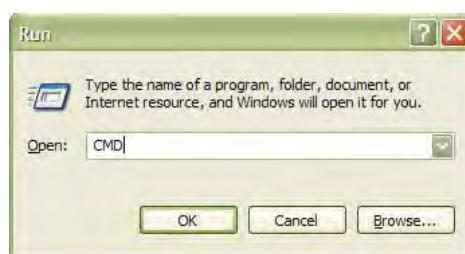
При использовании PC, который присоединен к такому же роутеру / точке доступа, как и оборудование DVR, запустите Командную строку – щелкнув по кнопке Пуск -> Запустить. В окно командной строки впишите CMD и щелкните по OK или нажмите ENTER.
