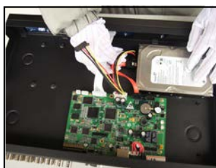
4. Należy podłączyć kable do przesyłu danych SATA
