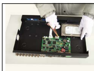
5. Należy zainstalować kable zasilające SATA
