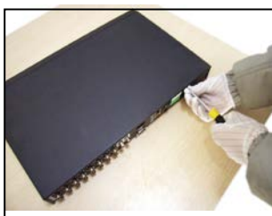
1. Z obudowy należy odkręcić śrubki
