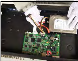
4. Csatlakoztassa a SATA adat kábelt a merevlemezhez
