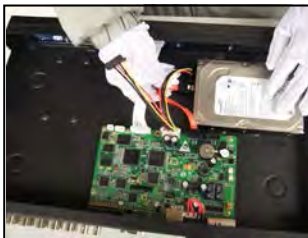
4. Należy podłączyć kable do przesyłu danych SATA
