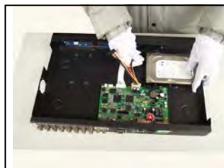
5. Należy zainstalować kable zasilające SATA
