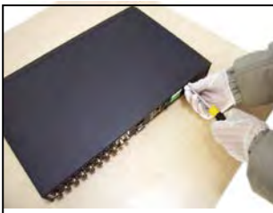
1. Z obudowy należy odkręcić śrubki
