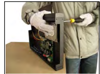
3. Należy zainstalować twardy dysk SATA
