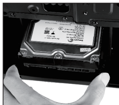
HDD konzolu vložte do násadca, vložte disk
